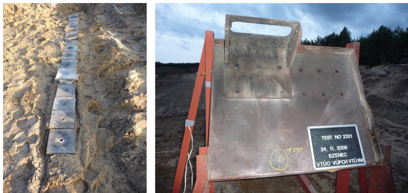
Obrázek 7: Testování účinnosti RPG-7 (vlevo), svědečný plech při nasazení AO (vpravo)
