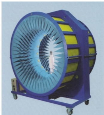
Obrázek 15: Speciální uspořádání měřicího prostoru pro testování EMI mobilů (Satimo)
