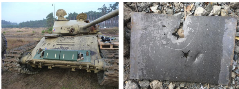
Obrázek 6: Mikrovlnné závor na tanku (vlevo), svědečný plech s výsledky (vpravo)
