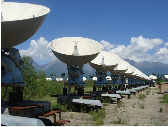
Obrázek 2: Část antén radioheliografu SSRT v Badarech před započítím rekonstrukce; v té době fungoval interferometr na principu zkřížených fázovaných anténních řad, s využitím multifrekvenčního svazku; nyní se přestavuje na přístroj s aperturní syntézou
