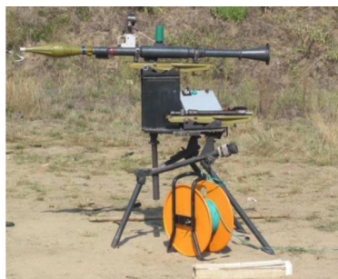
Obrázek 1: Rozměry typických ohrožujících střel (vlevo), střela RPG-7 v odpalovači (vpravo)
