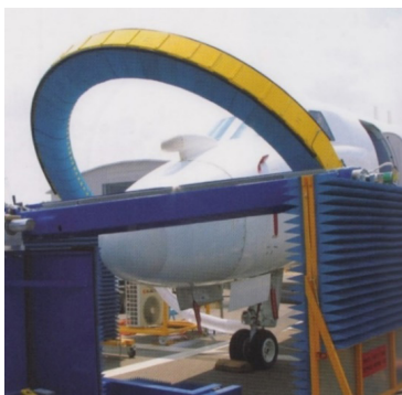
Obrázek 14: Speciální uspořádání měřicího prostoru pro testování EMI (Satimo)
