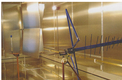
Obrázek 11: Reverberační (dozvuková) komora s „pádly“ (stirrers) homogenizující měření
