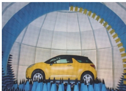
Obrázek 13: Speciální uspořádání měřicího prostoru pro testování EMI celého vozidla
