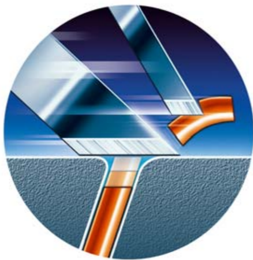
Pro hladké oholení používají frézkové strojky Philips dvojitý břit rotačního nože, planžetové strojky Panasonic ostří břitového bloku broušené pod úhlem 30° pomocí nanotechnologie.
