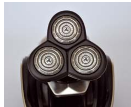
Hlava strojku je na pohyblivém kloubu a k tomu se ještě každá fréza na hlavě vyklápí kolmo na střed. Tím je velmi dobře zajištěno kopírování povrchu tváře.
