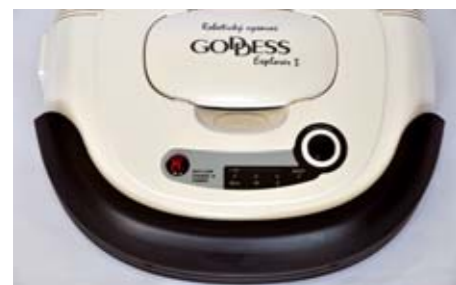
Jednoduchý ovládací panel s infračidlem a tlačítkem dovoluje ruční i dálkové nastavení režimů, které indikuje kontrolkami pro úklid „do vybití akumulátoru“, 40- a 20minutový nebo „vytření podlahy vlhkým hadrem“.
