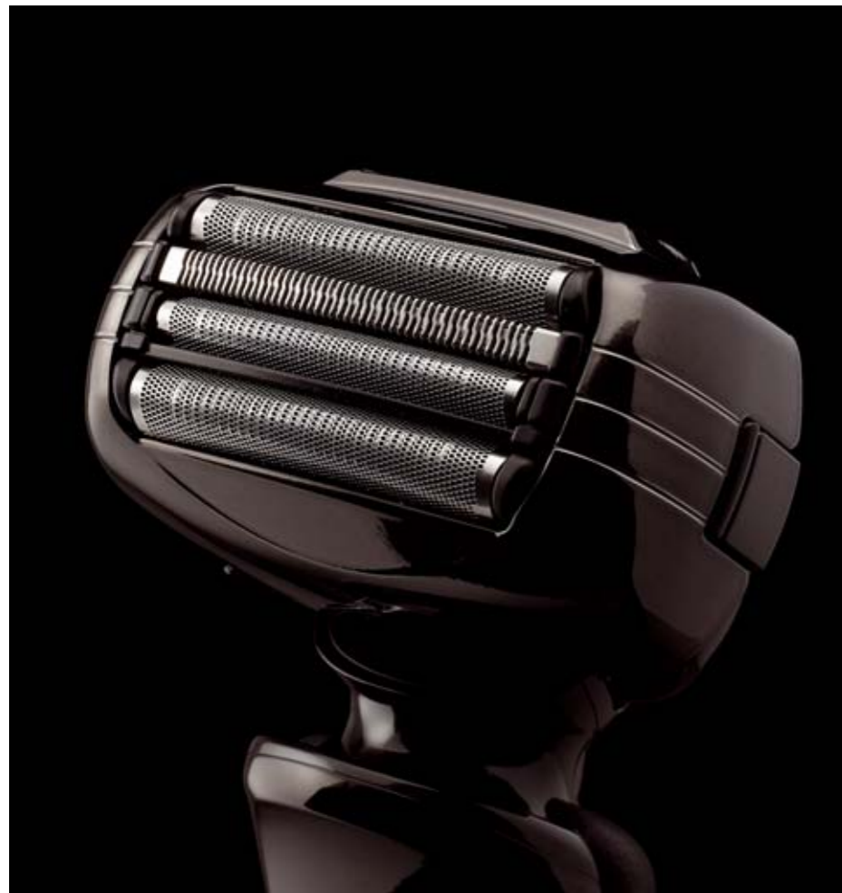
Hlava Panasonicu ES-LA93 je kyvná ve dvou osách což zajišťuje dobré kopírování tváře. O delší vousy se postará zastříhvací planžeta (2. shora), holicí planžety (1. a 4.) a o nejkratší vousy dokončovací planžeta (3. shora).
