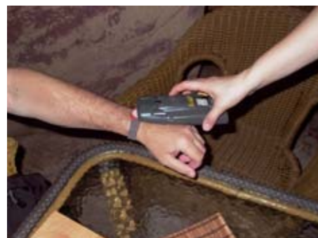
A takhle se tu platí – po příchodu dostanete očíslovaný náramek (šatnu si najdete podle něj), který přes kontakt s mobilním terminálem automaticky připočítá příslušnou částku na váš účet. Nebo ji – v případě vratné zálohy – zase odečte.
